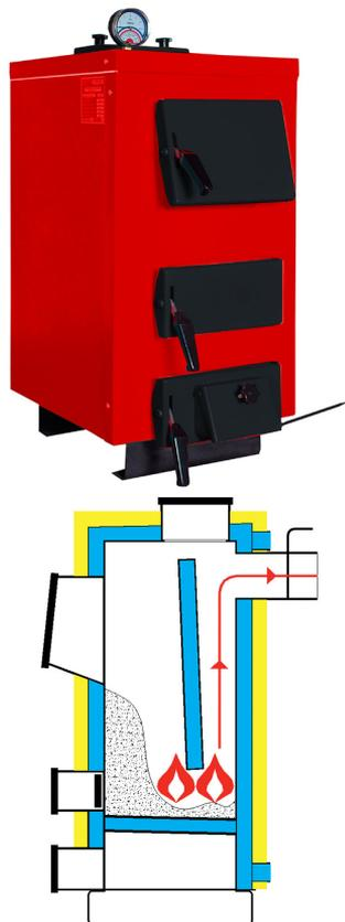
**miniLUX (6÷10 кВт)** – это типоряд универсальных, оптимальных по цене нагревательных котлов с нижней камерой сгорания и водотрубной решёткой, а также, по заказу, с регулятором тяги либо с контроллером и наддувом, предназначенных для обогрева малых объектов и квартир, и сжигания: **каменного и бурого угля, кускового дерева, щепы.**
